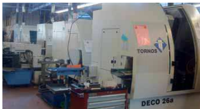
Vue partielle de l'atelier des DECO chez Décovi. Elles sont toutes reliées au système centralisé d'évacuation des vapeurs d'huile.
