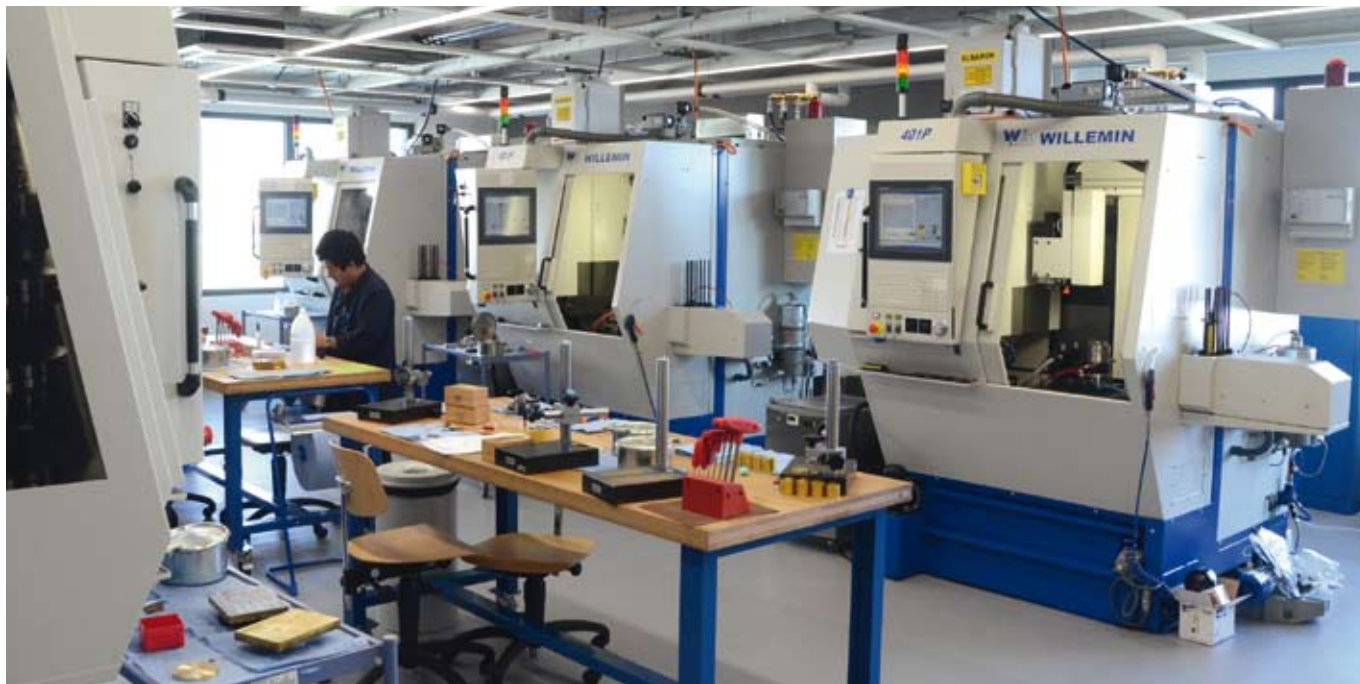
L'atelier "fraisage des complications" comporte six machines Willemin-Macodel, deux machines cinq axes et quatre trois axes. In der "Fräswerkstatt für die Komplikationen" arbeiten sechs Maschinen der Firma Willemin-Macodel, zwei 5-Achsen Maschinen und vier 3-Achsen Maschinen. The "complications milling" workshop consists of six Willemin-Macodel machines, two five axes and four three axes.
